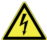
W012 Warnung vor elektri- scher Spannung
