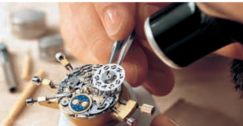
Traditionsreiches Handwerk, innovative Konstruktion: Montage des Großdatums am Beispiel einer Langematik Perpetual
